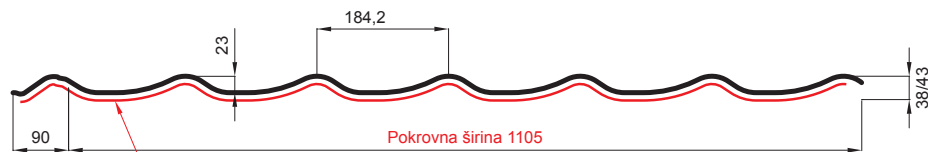
L – OPTIMALNA DULJINA POKROVA ZA MODUL 350 mm
