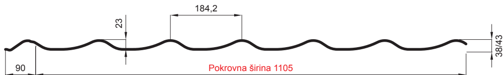
L – OPTIMALNA DULJINA POKROVA ZA MODUL 350 mm
